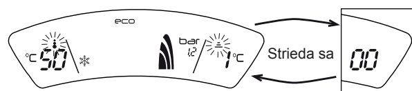
Fig.31 - Kotel v servisnom režime na 100% výkone
